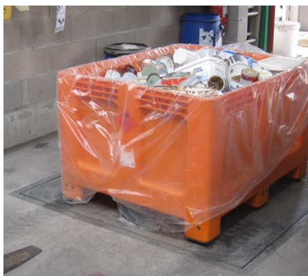
Pesée du bâtiment déchets dangereux
